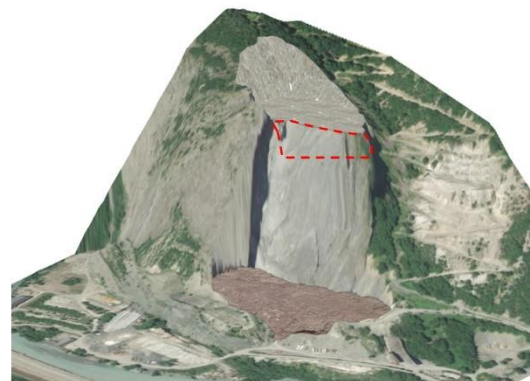
Simulation du projet en fin de phase 1 (0-5 ans) (en rouge : zone exploitée en phase 2)
